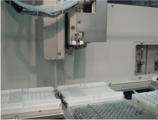
*Figure 11-2 8-Channel - 200 µL Pipette Tip Box*
